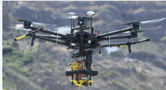
Sistema de control de plataformas de vuelo no tripuladas (drones) provistos de sensores de distinto tipo (entre otros, multi-hiperespectral y RGB) que permiten inspeccionar áreas de manera autónoma y recursiva, para proporcionar datos en tiempo real sobre una superficie determinada.
